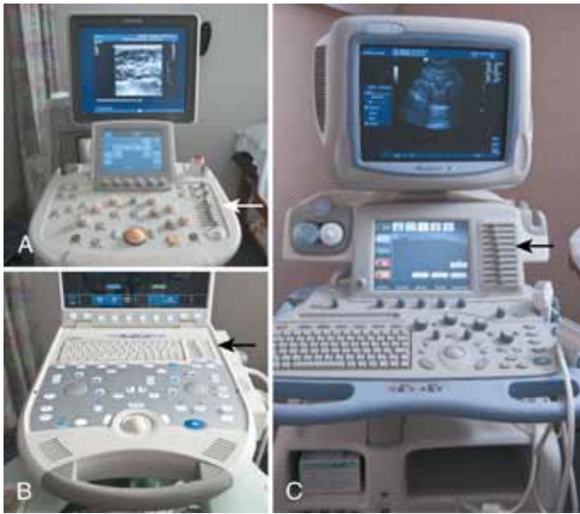
Fig. 1.2. Paneles de control de distintos ecógrafos del año 2010. A , Philips IU22. B , Biosound Esaote MyLab gold. C , GE Logiq. Aunque los aparatos modernos son digitales, sus controles pueden realizar ajustes continuos o en pasos incrementales. El panel de compensación de la ganancia temporal de cada aparato se indica con flechas.
